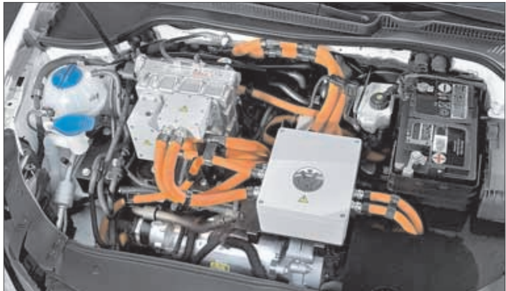
Im „Motorraum“ des Golf blue-e-motion sieht es aufgeräumt aus. Hier findet man den 80 kg schweren Elektromotor, die Steuerungs- und Ladeelektronik, eine normale 12-Volt-Bordnetzbatterie. Auch das Eingang-Getriebe ist hier verbaut.
