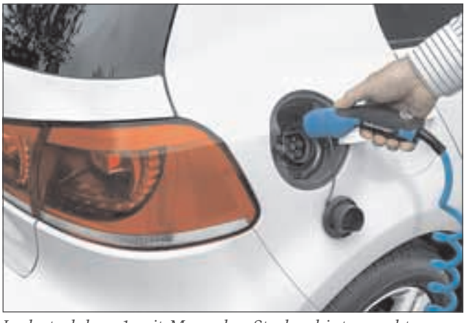
Ladesteckdose 1 mit Mennekes-Stecker hinten rechts...
